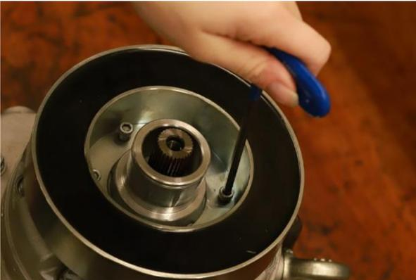
2) Alinhe os furos de fixação correspondentes entre a bobina e o mancal frontal do compressor.
