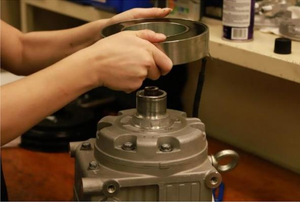
1) Posicione a bobina de campo corretamente com a guia de Metal no topo.
