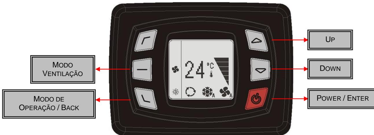
O painel de controle, instalado no painel do piloto, contém a CPU principal e é composto de um teclado para programação operacional do sistema de ar-condicionado, e de um display para visualização: de parâmetros, do status de operação, tensão da bateria e da temperatura.
